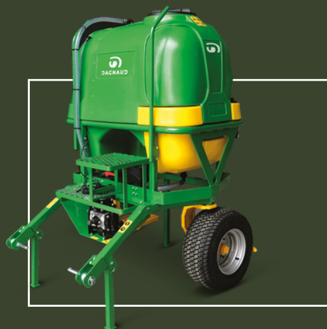
Cuve additionnelle trainée 600 litres Attelage sur pulvérisateur Dagnaud DCAT-600
